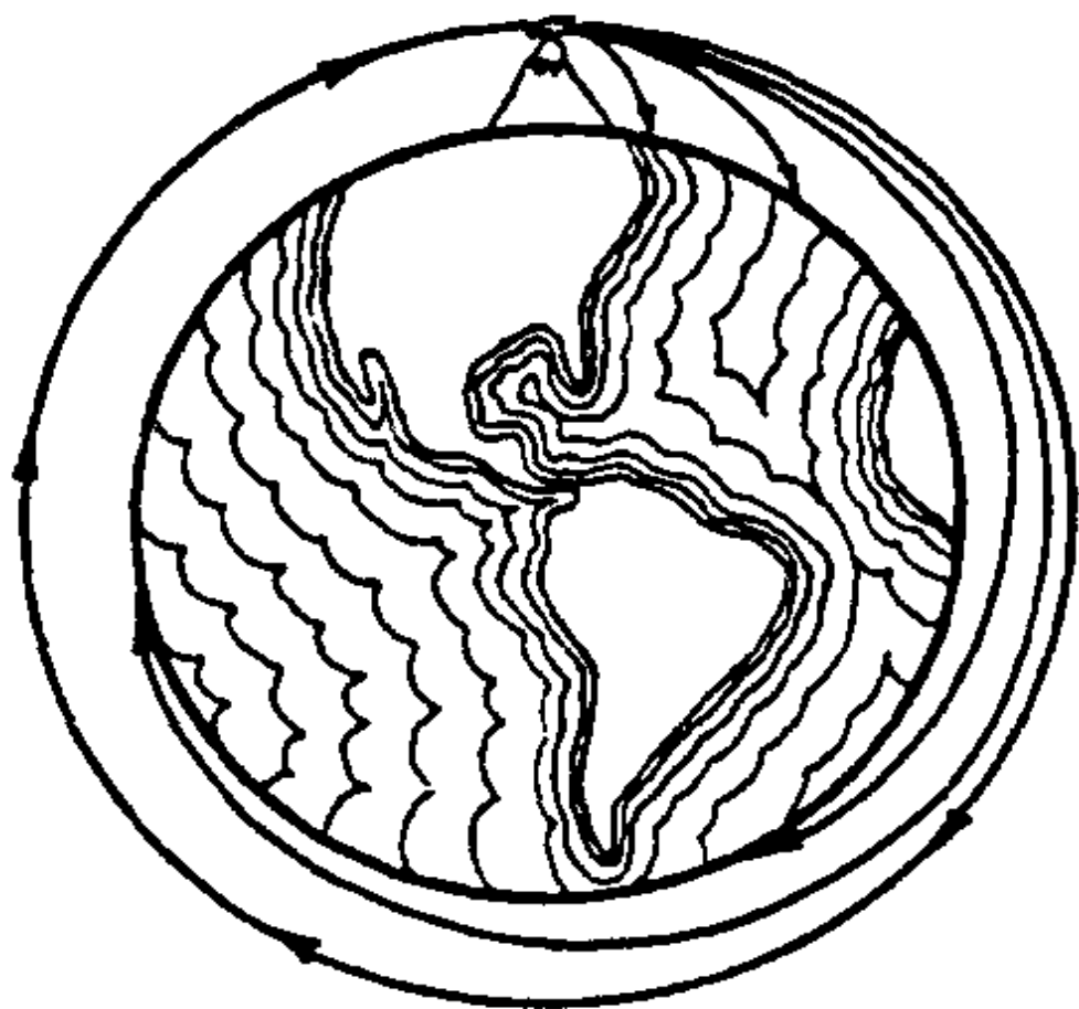
图 51. 牛顿对作为卫星的炮弹的描述。当炮弹的速度增加时,它的轨迹也增长,从而绕地球的曲面运行得更远。当速度足够大时,炮弹不再落向地面,而是沿着近似的圆形轨道连续旋转。
