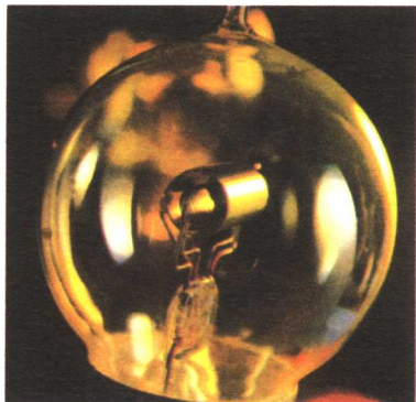
▲真空二极管，玻璃壳中的圆柱形套筒是收集电子的阳极，其中的螺旋金属丝是加热发射电子的阴极
