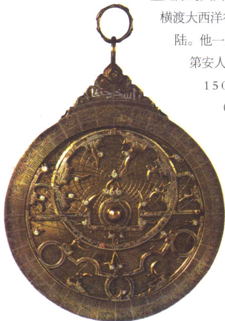
▲ 公元13世纪埃及阿尤布王朝时期的星盘，航海时用于测量星体仰角，帮助水手确定纬度，星盘直径24.8厘米，黄铜制造，盘上刻有开罗和亚历山大城的纬度（存大英博物馆）
