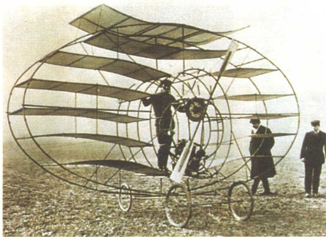
▲ 法国曾经试验过的多翼飞机，设计者以为机翼越多升力越大
