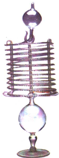
► 17世纪初意大利制造的玻璃温度计，螺旋形多圈细玻璃管可以使人们察觉微小的温度变化
