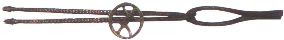
▲ 古罗马人用以夹持金属锻件的工具，巧妙的是，只在一侧柄上有可以滚动的轮子，有了这个滚动的支点，既省力又能够方便地移动工件位置。长40.7厘米，宽6厘米，公元1世纪，庞贝遗址出土（存那不勒斯国家考古博物馆）
