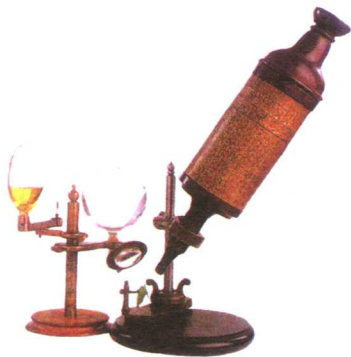
▲早期的显微镜，采用了巧妙的办法用辅助光源照亮被观察的物体
