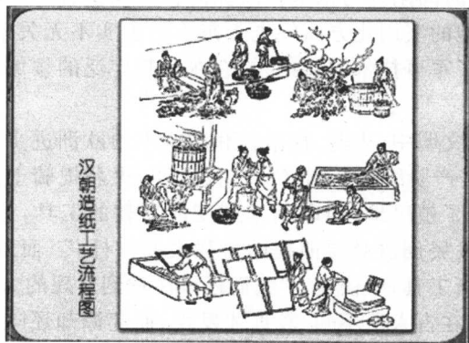
图 9-7 汉朝造纸工艺流程图
